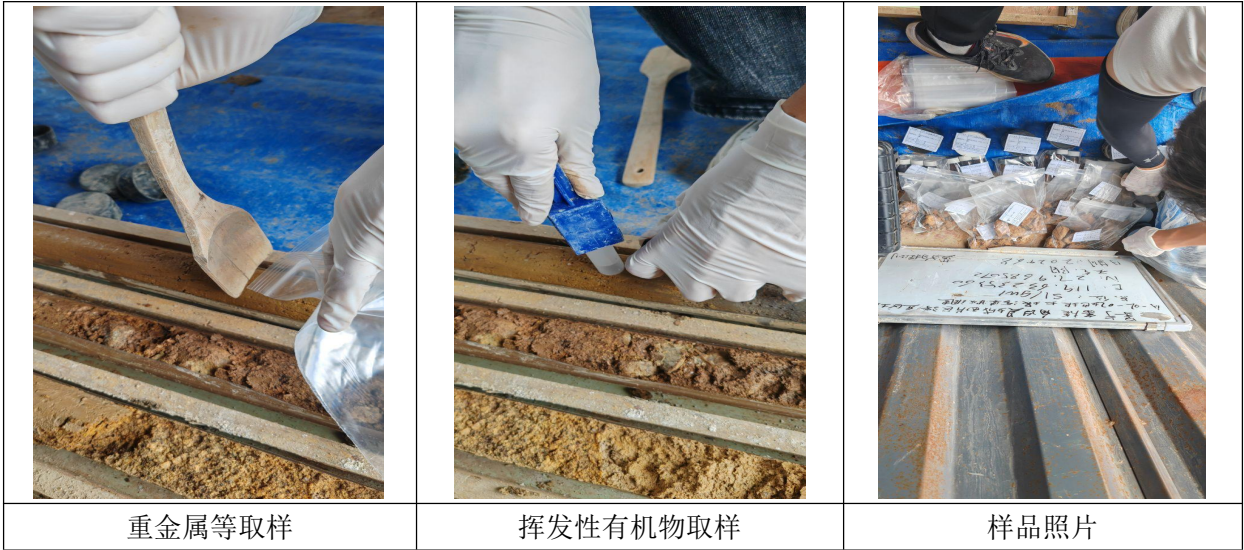
图 5.2-1 土壤样品采集照片（以 S1 为例）
